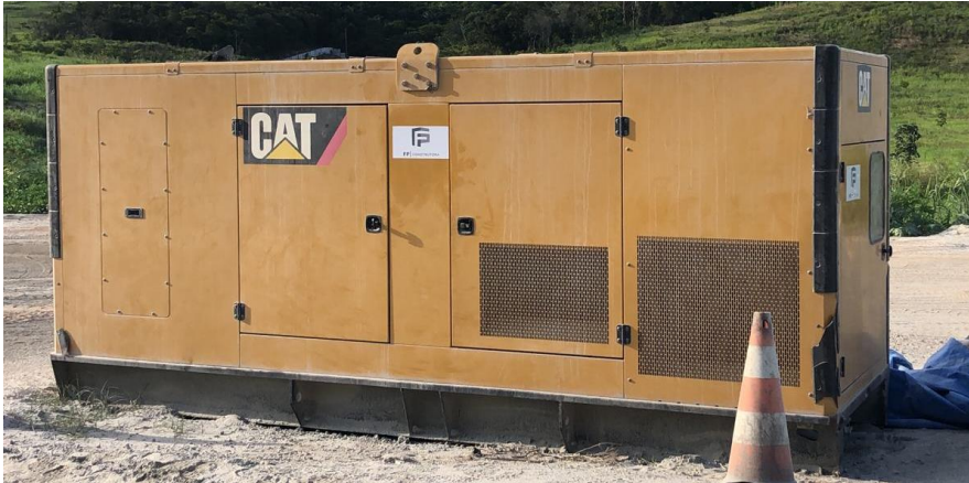
Grupo gerador estacionário CATERPILLAR - 500KVA – Pátio de Maquinas FP Construtora Ltda
